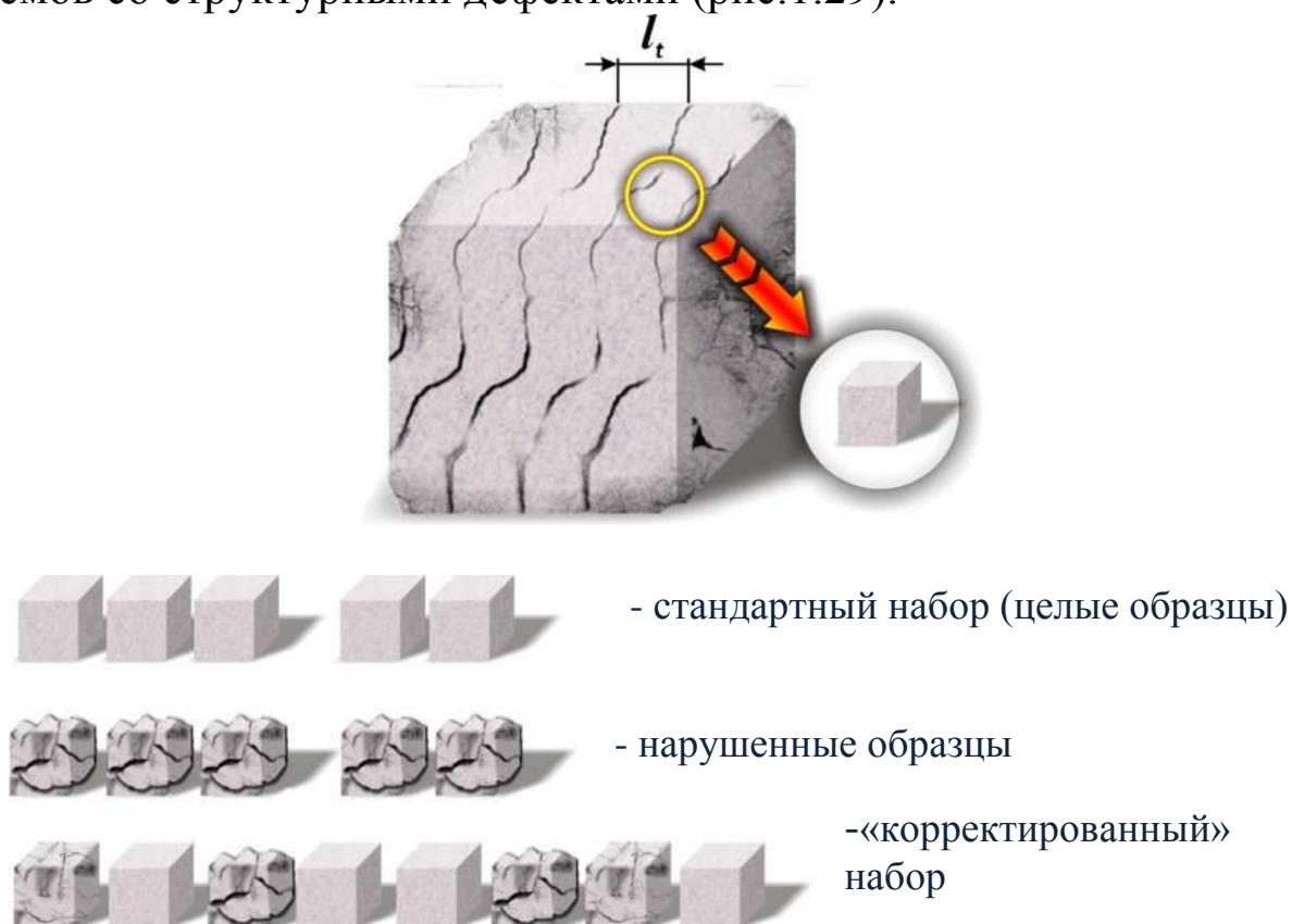
Рис. 1.29. Расчетная схема к решению задачи о структурно-механическом ослаблении породного массива
